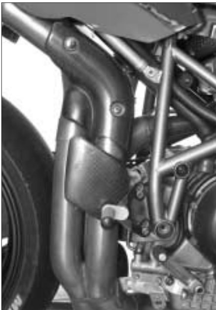
Bild 14: 57er-Krümmerrohre, superleichte Fußrastenanlage.
