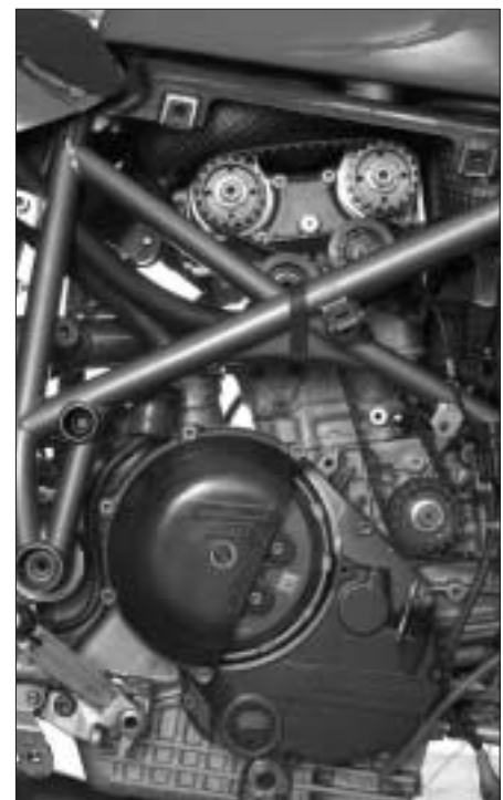
Bild 28: Leichte Zahnriemenräder aus Ergal und STM-Rennkupplung mit sechs einzelnen Druckfedern.
