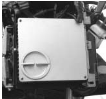
Bild 17: Bei der Rennmaschine sitzt die Recheneinheit vor dem Lenkkopf.
