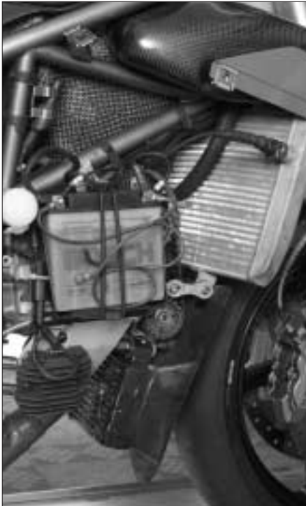
Bild 9: Extra große Wasser- und Ölkühler, kleine 6 Ah-Batterie.
