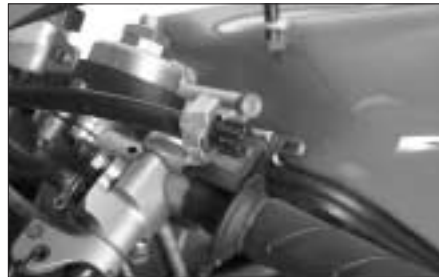
Bild 2: Nachstelleinrichtung des Bremshebelabstands von der linken Seite aus.
