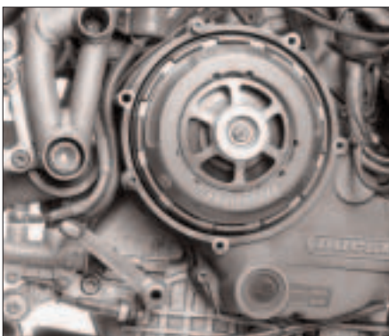
Bild 26: Leichte STM-Kupplung mit Zentralfeder für Straßen-Ducs.
