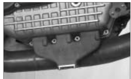
Bild 13: Aufgesetzte Ölwanne zur sicheren Schmierung bei Wheelies.
