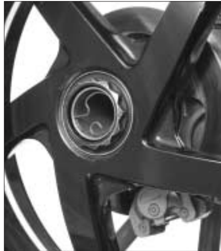
Bild 6: Bei der Rennmaschine wird der Hinterradmutter-Splint von innen eingesetzt.
