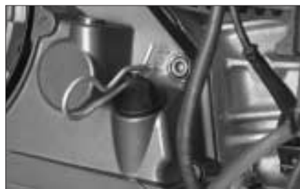
Bild 11: Sicherungssplint im Ölstopfen, für Serien-Sportduc's empfehlenswert.
