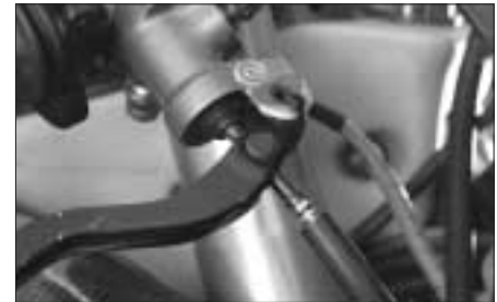
Bild 3: Der Einstellbowdenzug führt nach rechts zum Hebel der 19er-Bremspumpe.
