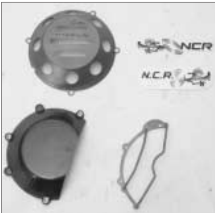
Bild 23: Titan-Kupplungsabdeckungen in verschiedenen Formen von NCR.
