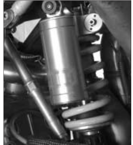
Bild 7: Öhlins-Rennfederbein. Man beachte die extra dicke Schubstange.
