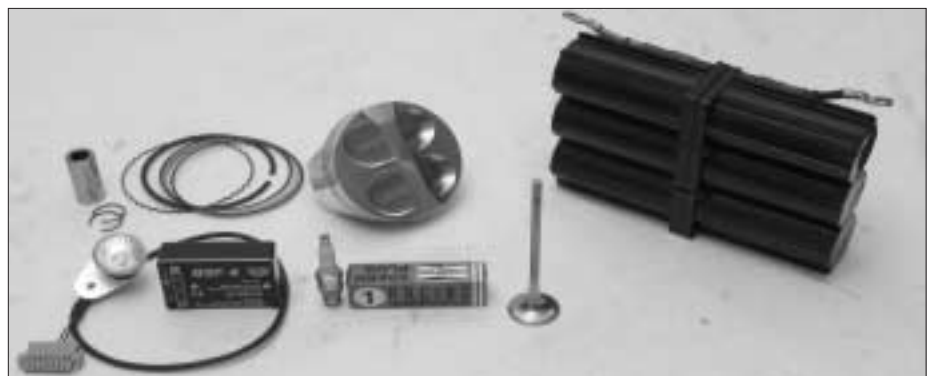
Bild 27: Gemäßigte Tuning-Teile wie Schaltblitz, höhere Kolben, leichter Batteriepack, Titanventile und spezielle Champion-Racingzündkerzen.
