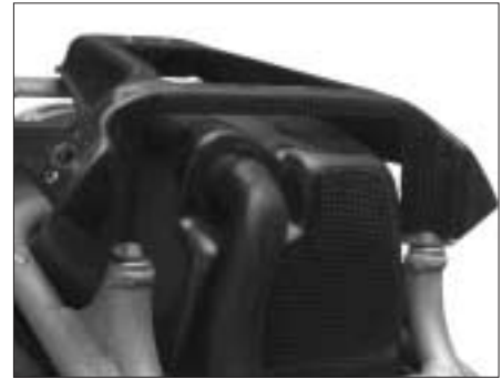
Bild 12: Der Entlüftungsbehälter für den Motor sitzt im Rahmenheck.
