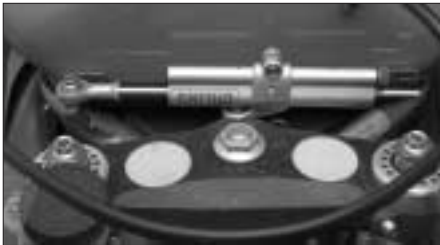
Bild 16: Der Öhlins-Lenkungsdämpfer ist ein Muss an einem Rennmotorrad.
