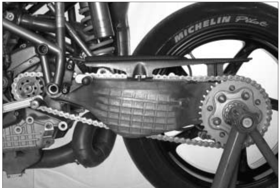
Bild 15: Die Magnesiumschwinge ist nicht nur extra dick, sondern auch
